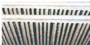
(左) 酵母反应槽状态 (右) 反应槽内部状态 酵母被固定在线形过滤材料上
